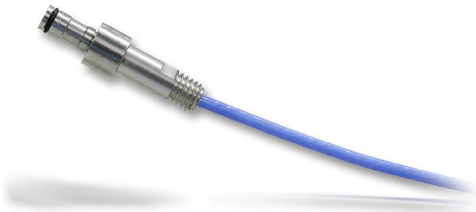
La cavité piézoélectrique encastrée de 4 mmmpression Le capteur 6157 de RJG, Inc. est un capteur à canal unique ou multicanal qui peut supporterles forces jusqu'à 29 008 psi (2 000 bar) et une température maximale de 392 °F (200 °C).
