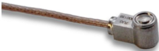
Le 9210 est une cavité piézoélectrique de 3,5 mm (0.14") de type bouton, indirecte (sous broche) à canal unique ou multicanal pression capteur conçu pour être utilisé avec les systèmes de contrôle et de surveillance de processus RJG, Inc. eDART® ou CoPilot®.
