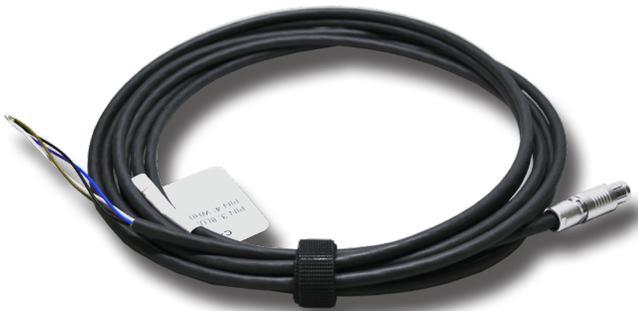
Le câble C-IA1/LX-4M assure l'interface entre RJG, Inc. Module d'entrée analogique à montage en surface Lynx™ IA1-S-VI-24 et le système eDART® ou CoPilot® avec des capteurs qui émettent des signaux de 0 à 10 V ou de 4 à 20 mA. De plus, le module d'entrées analogiques à montage en surface Lynx peut fournir une alimentation 24 V via le C-IA1/LX4-M pour alimenter certains capteurs.
