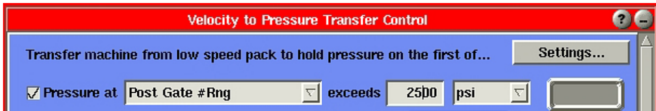
Figure 15 : entrer le point de consigne de transfert sur le Post-seuil #Rng (écran de transfert V->P)
