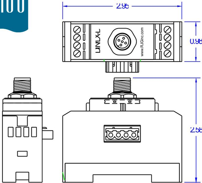
Le DIN/LX-D est un module de communication à rail DIN qui agit comme interface entre les câbles Lynx standards et les modules Lynx montés sur rail DIN lorsqu'on utilise un ID7-D-SEQ. Le DIN/LX-D est conçu pour être utilisé avec le système eDART®.
