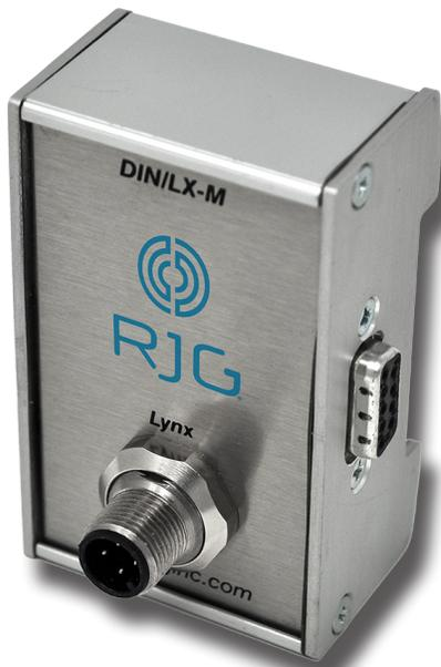
L'adaptateur de communication blindé Lynx™ DIN/LX-M est un module de communication Lynx-to-DIN-rail qui sert d'interface avec d'autres RJG, Inc. Modules montés sur rail DIN blindés Lynx aux systèmes eDART® ou CoPilot® lorsqu'un module de séquence blindé Lynx ID7-D-SEQ n'est pas utilisé. Ce module à rail DIN est blindé pour assurer l'obtention de données de haute qualité, même dans des environnements de moulage difficiles.
