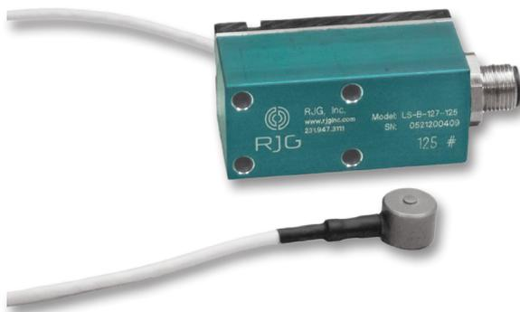
Les LSB127-50/125/500/2000 sont des capteurs de pression empreinte de type bouton, à jauge de contrainte numérique à canal unique, indirects (sous la broche), de 0.50" po (12,7 mm) conçus pour être utilisés avec le RJG eDART® ou CoPilot® système de contrôle et de surveillance des processus.
