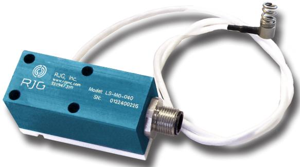
Le capteur de déviation de moule Lynx LS-MD-040 mesure jusqu'à 0.040" (1,016 mm) de déviation de moule à la ligne de séparation à chaque cycle pour une utilisation avec le système eDART® ou CoPilot®.
