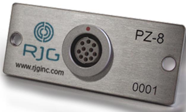
Le connecteur piézoélectrique à huit canaux avec faculté d'identification du moule permet de connecter jusqu'à huit capteurs piézoélectriques à l'adaptateur de capteur piézoélectrique à huit canaux PZ/LX8F-S-ID ainsi qu'au système eDART® ou CoPilot®.
