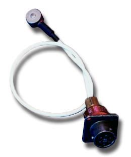
Les capteurs analogiques à jauge de contrainte à canal unique T-445 sont des capteurs de pression d'empreinte indirects (sous la broche) de type bouton de 0,625" (15,88 mm) qui peuvent résister à des forces allant jusqu'à 4 000 lb. (17,79 kN) et températures jusqu'à 250 °F (121 °C—capteurs standard) ou 425 °F (218 °C—capteurs haute température).
